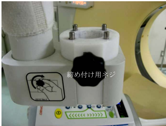
図 5 支持器の受け部分の構造
