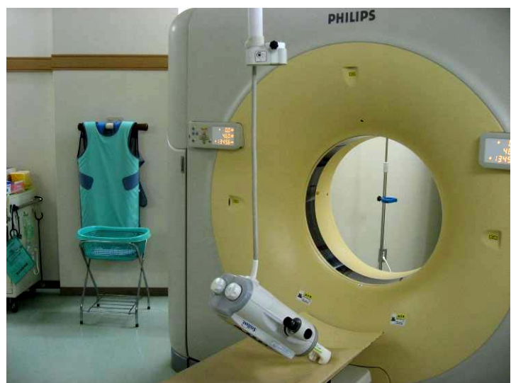
図 6 落下した状態のインジェクター
